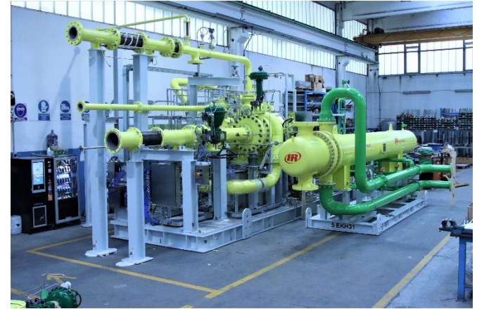
MSG centrifugal compressor for natural gas
