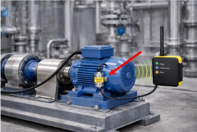
Figura 1. Motor con sensor de vibración instalado. Imagen generada con la instrucción 'Motor con sensor de vibración instalado' por OpenAI, ChatGPT, 2026.
