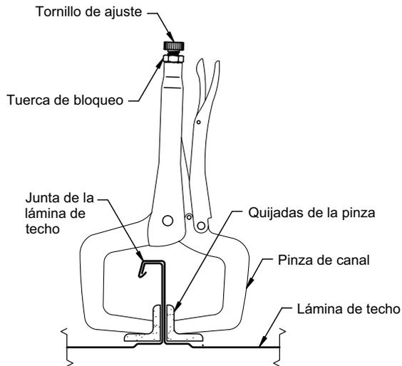
DETALLE DE LA PINZA DEL MÓDULO
