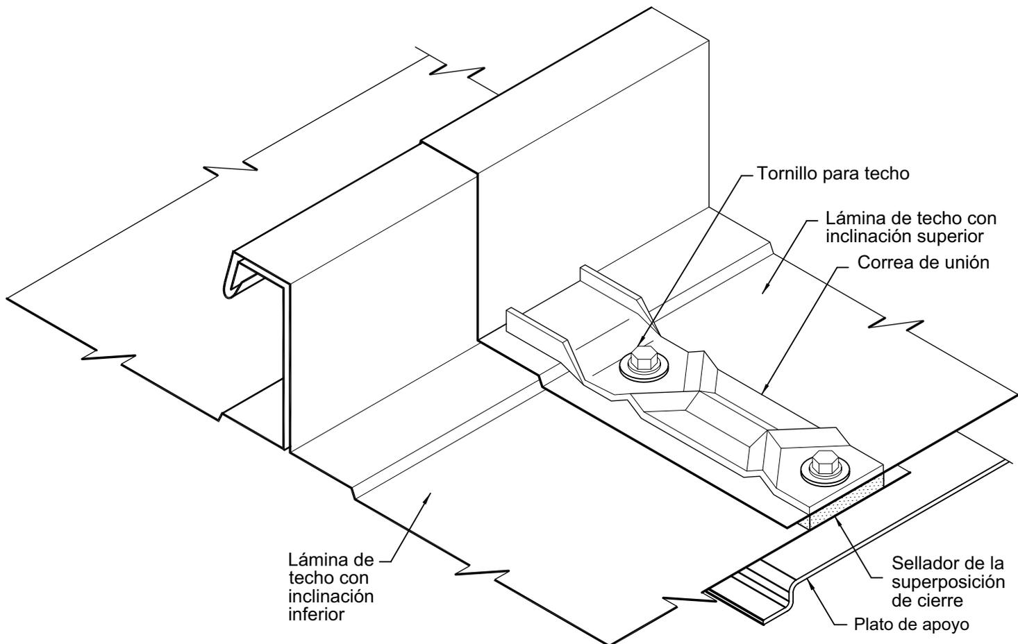
Verifique que la superposición esté ensamblada correctamente, como se muestra.
