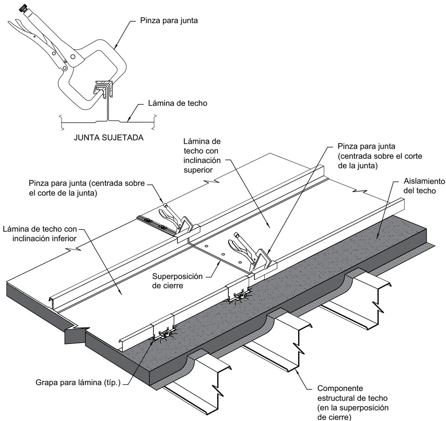
Use las pinzas para juntas para acercar y juntar las juntas de la lámina que se traslapan, como se muestra.
