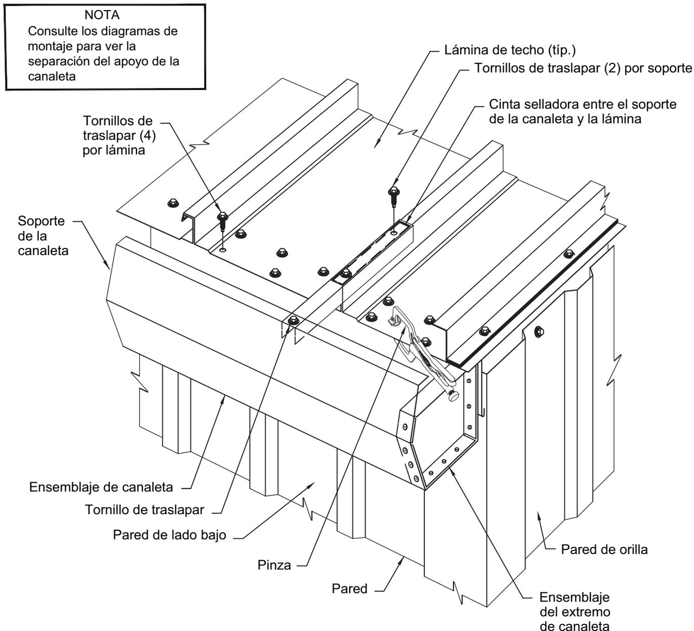
Levante el ensamblaje de la canaleta a su posición debajo del borde de las láminas de techo y sujete con pinzas de manera temporal el reborde posterior de la canaleta a la lámina de techo.
