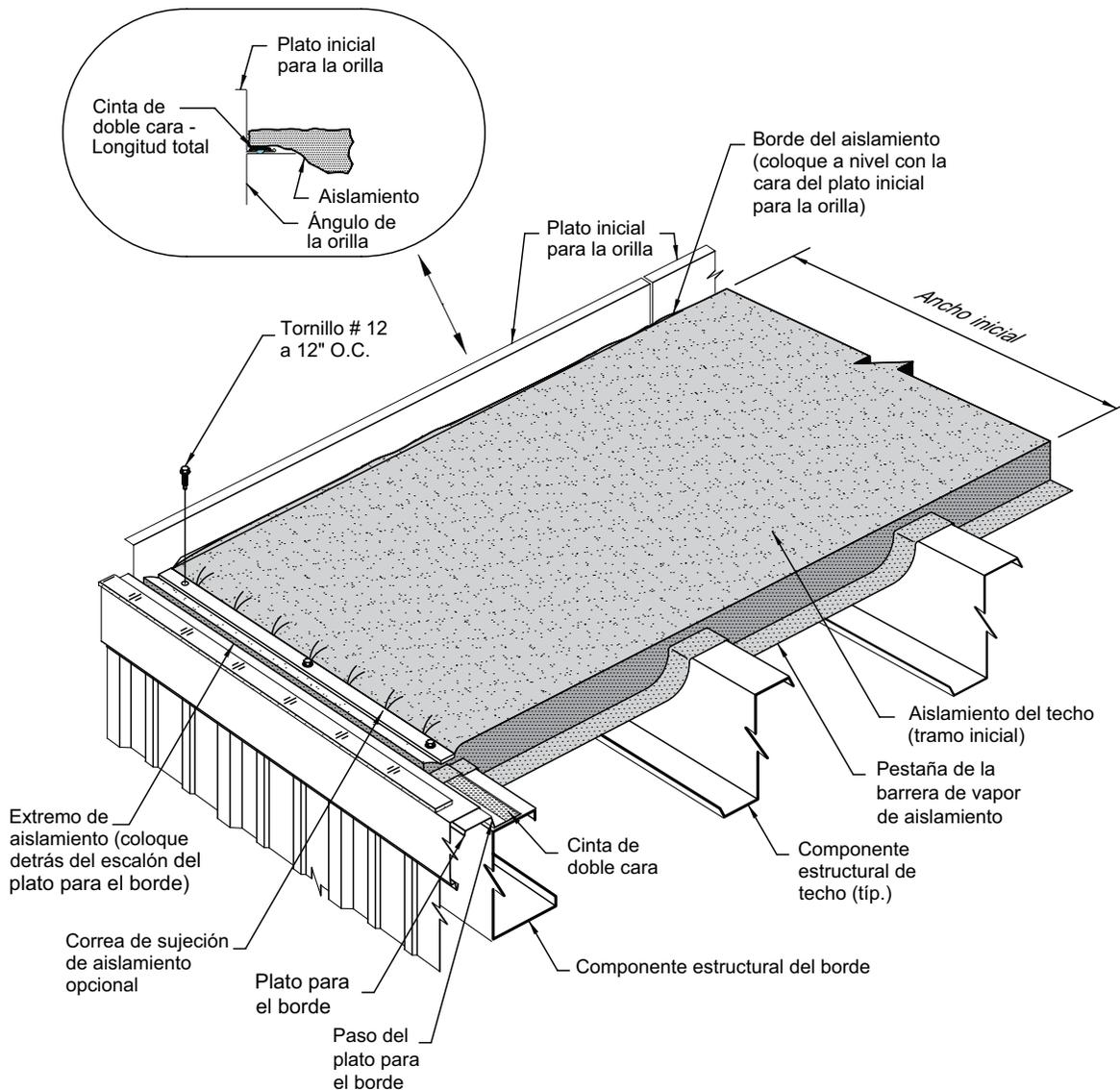
Consulte los diagramas de construcción para determinar el aislamiento específico requerido para el proyecto. En todos los casos, consulte las instrucciones del fabricante del aislamiento para instalar correctamente el aislamiento y ensamblar el sello de vapor. Este detalle muestra el aislamiento con la capa de aislamiento de fibra de vidrio, que es el aislamiento utilizado más usualmente para techos con junta de plegado saliente de metal.
