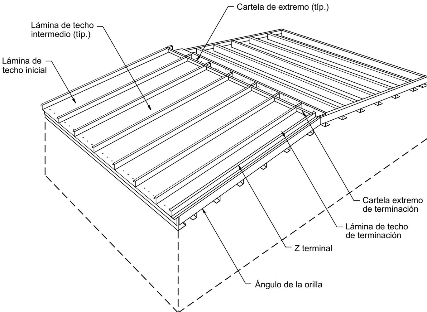
Se usan cartelas de extremo de metal para cerrar los extremos de las láminas de techo en la cumbrera, el borde alto y las condiciones de transición del borde alto.
