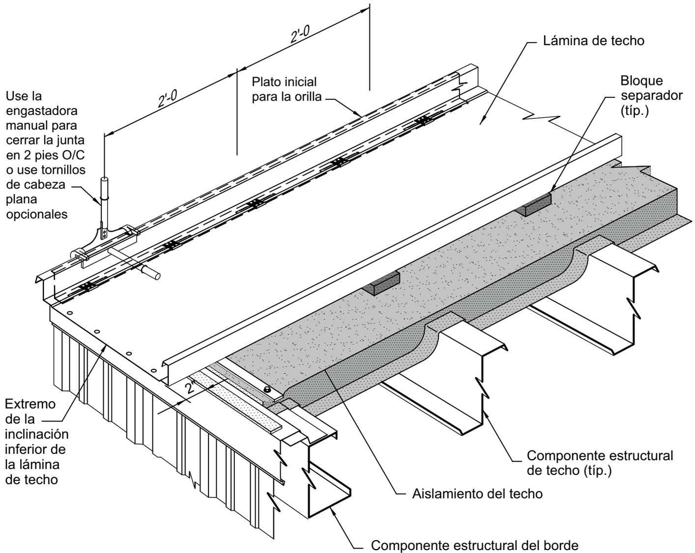
Verifique que la dimensión del voladizo de la lámina de techo esté correcta y verifique que la lámina de techo esté alineada y paralela a la línea de la orilla. Levante la esquina inicial de la lámina y retire el papel protector del sellador del borde.
