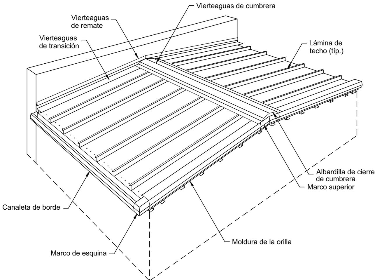
Los detalles en esta sección muestran el ensamblaje y la instalación de la canaleta del borde.
