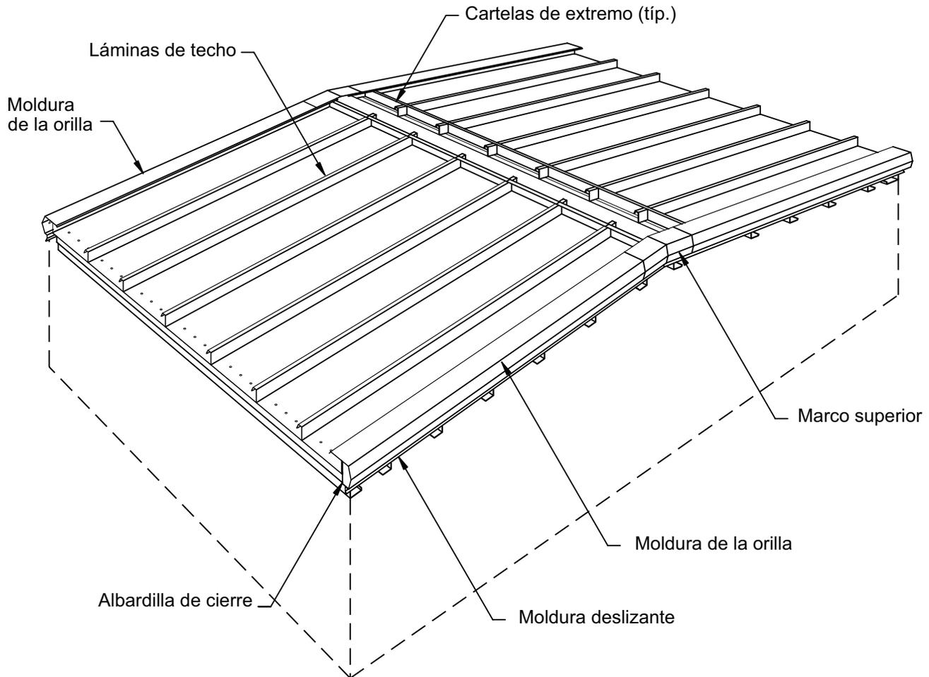
Los detalles en esta sección muestran la instalación de la moldura de la orilla, el marco superior y las albardillas de cierre.
