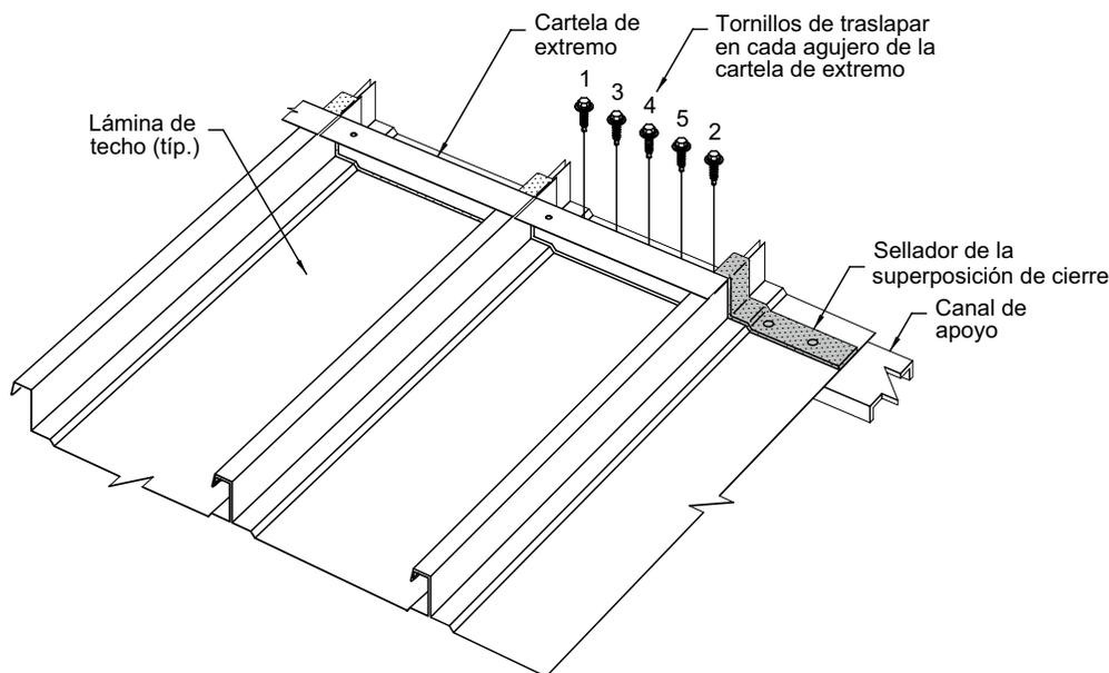
Presione de manera uniforme la cartela de extremo sobre el sellador de la cumbrera para asegurar la adhesión. Use una pinza para sostener unido el ensamblaje mientras instala los tornillos.
