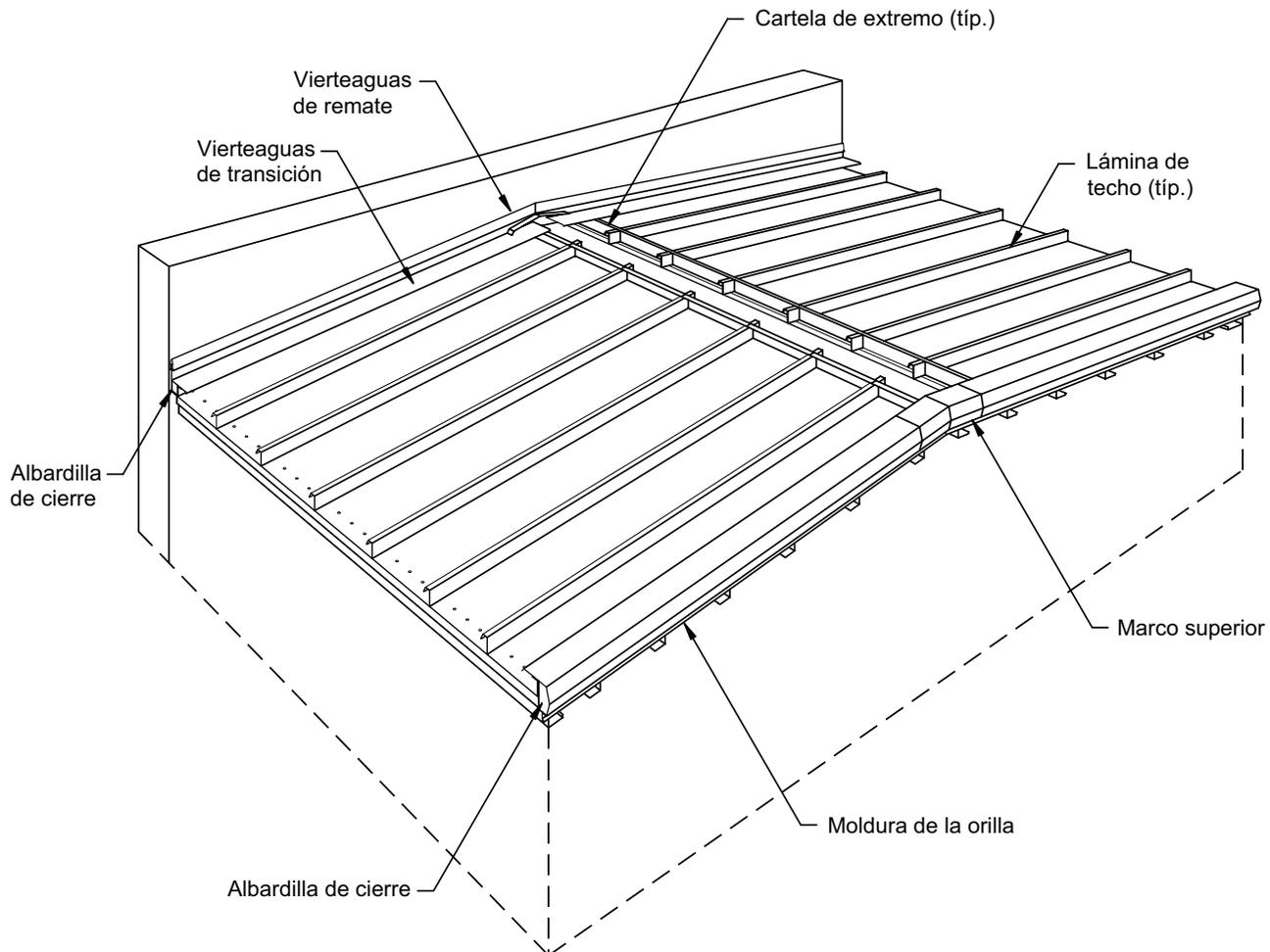
Los detalles en esta sección muestran la instalación del vierteaguas de la transición de la orilla.
