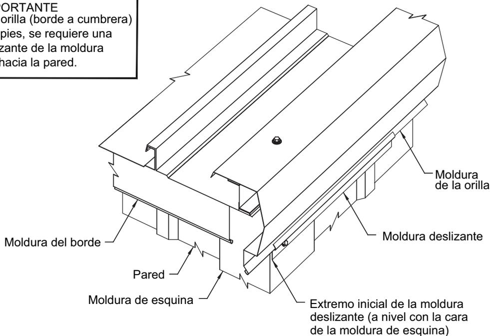
Si el tendido de la moldura de la orilla es de 25 pies o menos, el borde inferior de la moldura de la orilla se puede fijar directamente a la pared con tornillos para pared, como se muestra.
