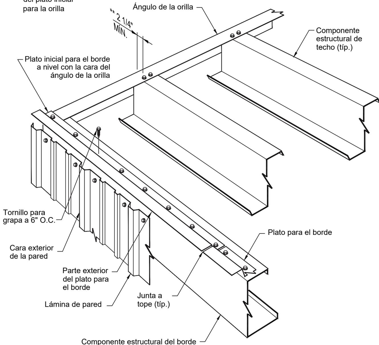
El plato para el borde proporciona una superficie sólida de fijación para el extremo del borde de la lámina de techo y eleva la lámina de techo para que coincida con la altura de separación de la grapa de la lámina.
