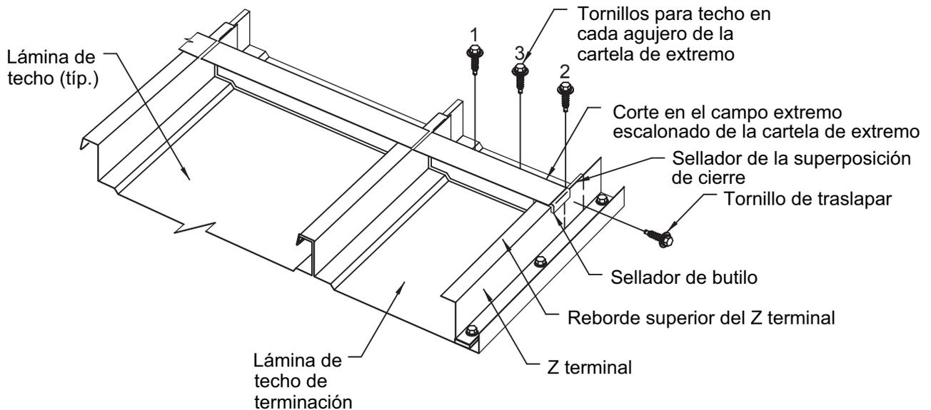
Se debe modificar en el campo una cartela de extremo para que quepa entre la nervadura de la lámina de techo y la Z terminal.
