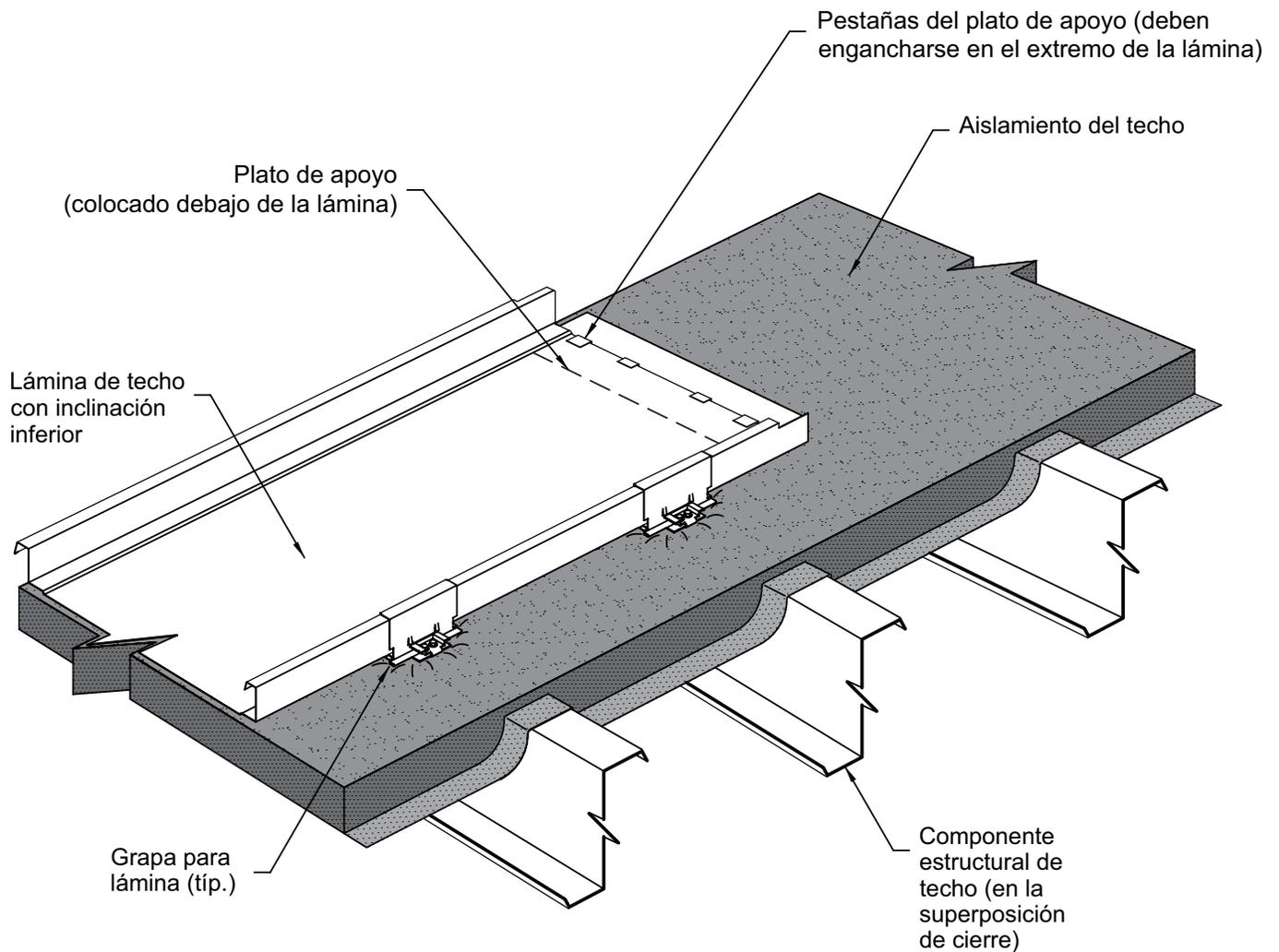
Deslice el plato de apoyo debajo del panel de techo, como se muestra.
