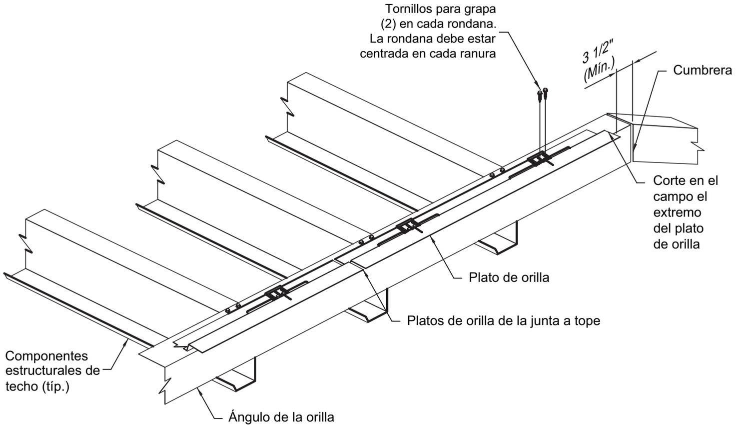
Una a tope los extremos del plato de orilla. Instale los tornillos estructurales en las rondanas, 2 por rondana, centrados en las ranuras.
