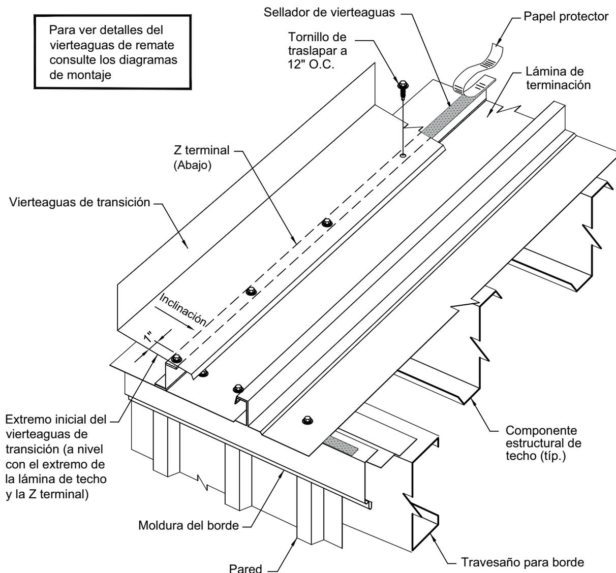
Instale la Z terminal de acuerdo con los detalles de la moldura de la orilla estándar. Instale el vierteaguas de transición del borde a la cumbre, para permitir la captación en los empalmes.
