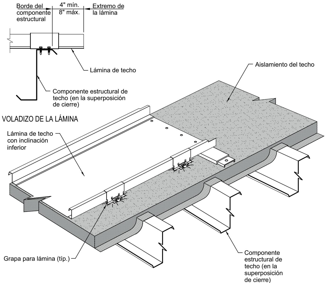
Con el extremo del borde de la lámina de techo fijado, mida el voladizo de la lámina en el miembro estructural del techo de superposición de cierre (vea la ilustración).
