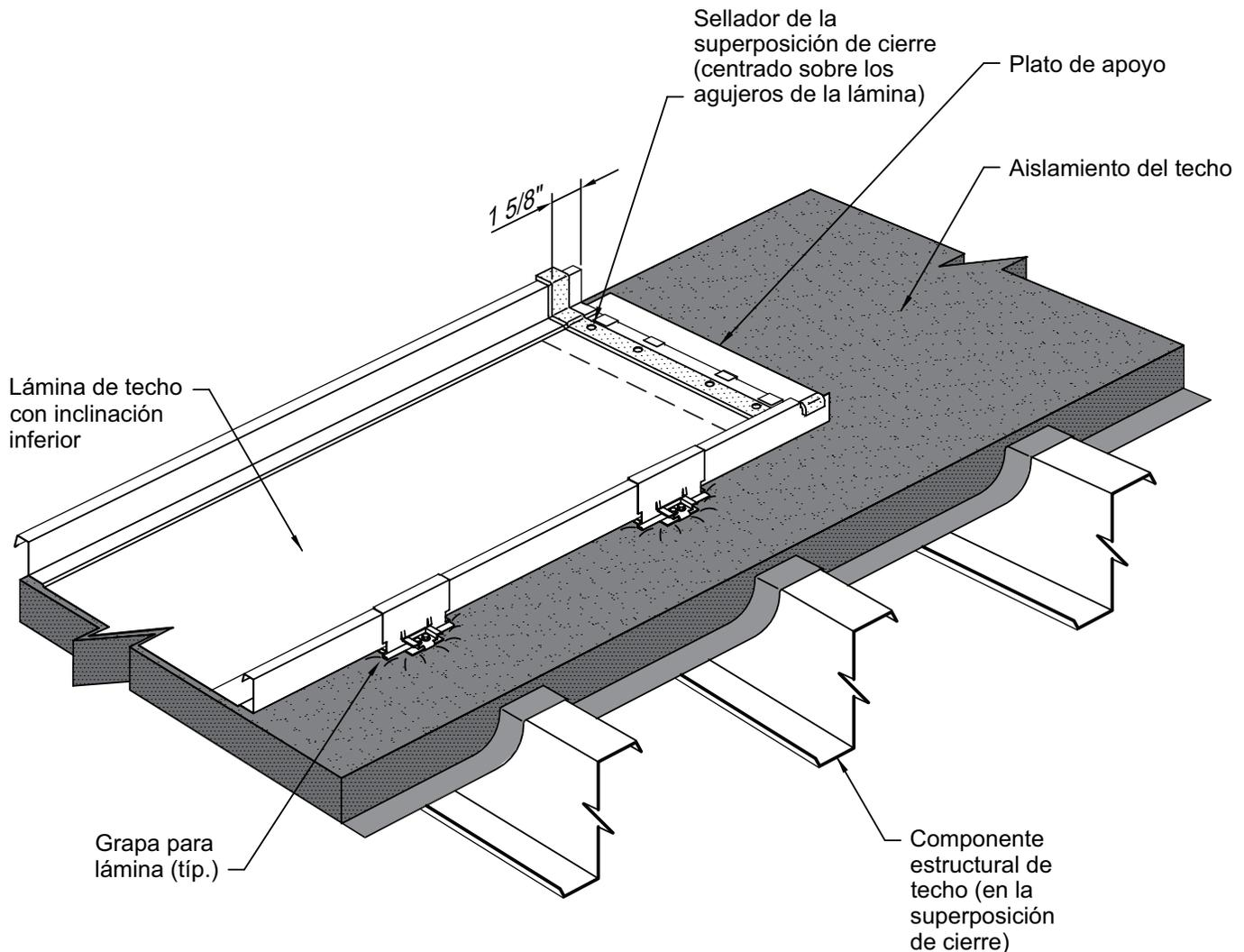
La colocación adecuada del sellador en la superposición de cierre es crítica para la hermeticidad ante el clima de las superposiciones del techo.
