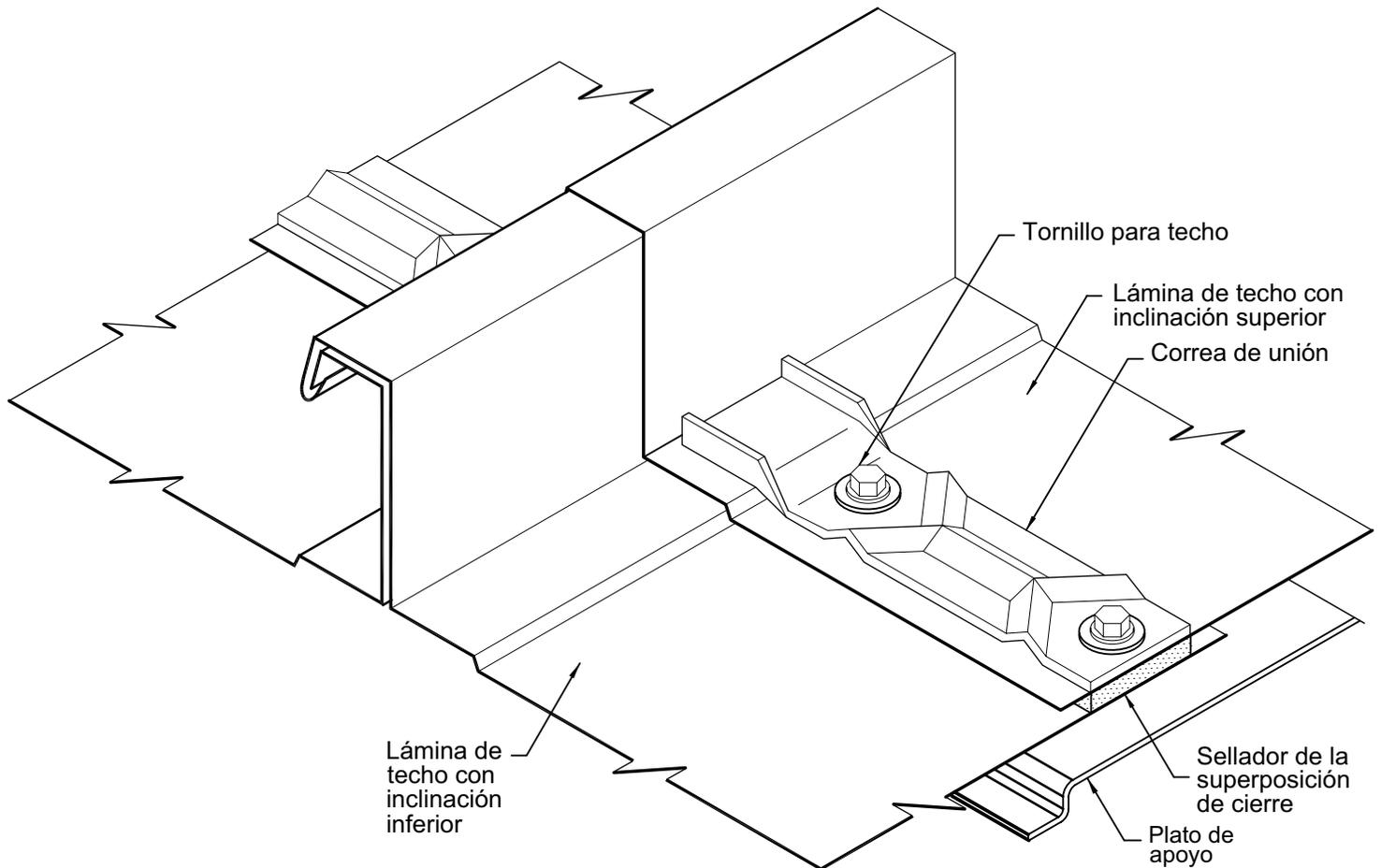
Verifique que la superposición de cierre esté ensamblada correctamente, como se muestra.
