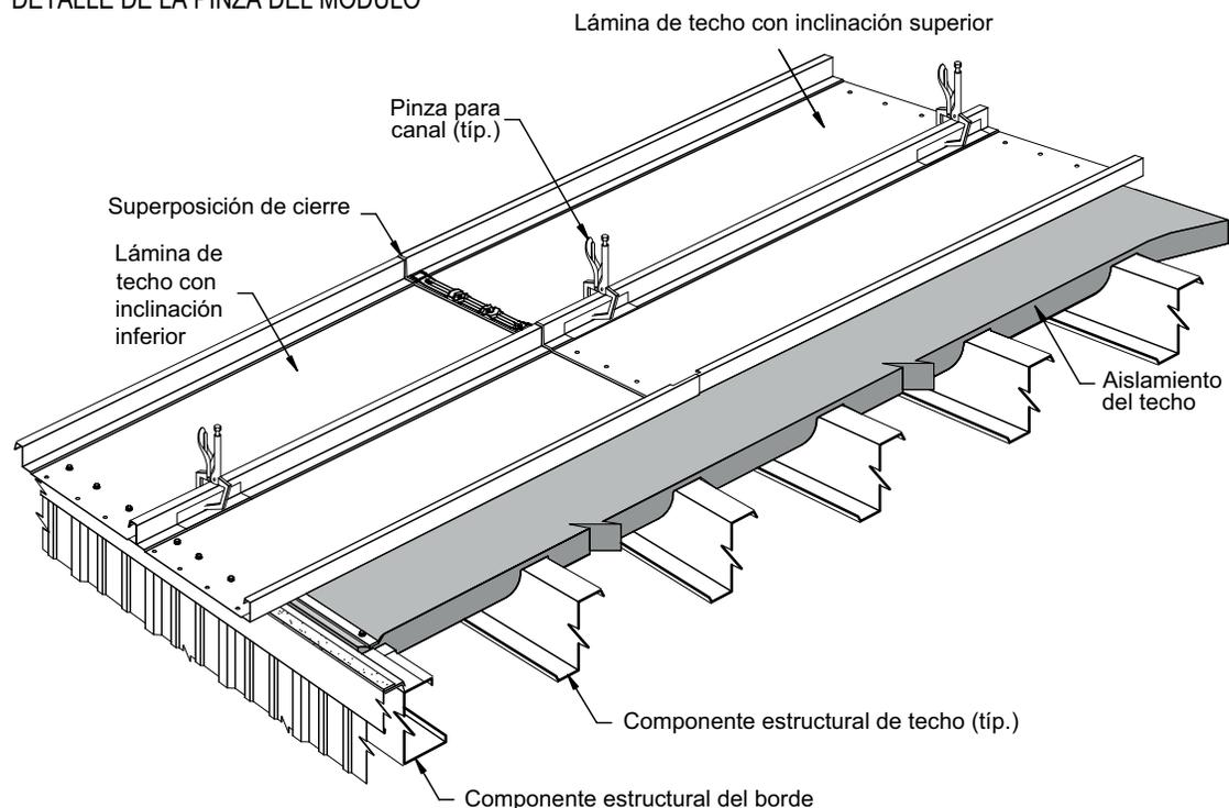
El error más usual en la cobertura es la propagación de los traslapes de las láminas de techo, en especial en los extremos de las láminas. Esto puede ocasionar una cobertura excesiva de la lámina a lo largo del borde, de las superposiciones de cierre y de la cumbre.
