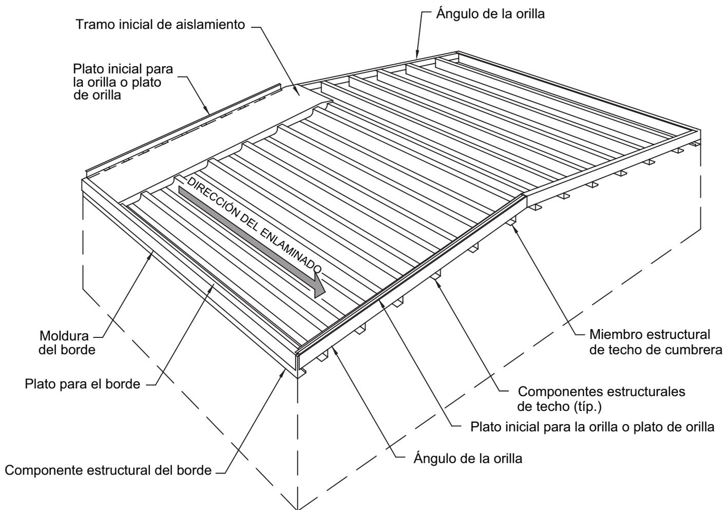
Preparación para instalar la lámina de techo
