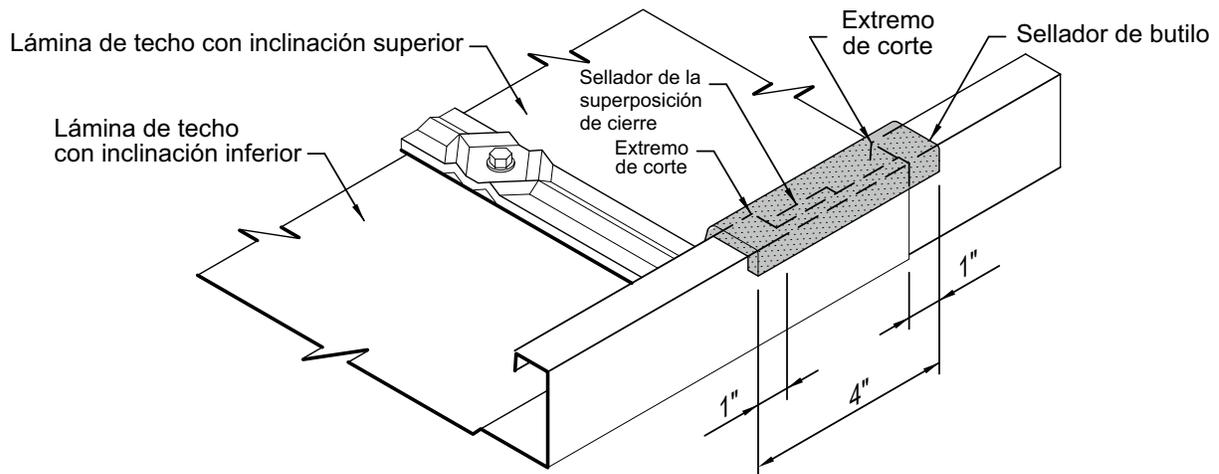
Usando una navaja o tijeras, corte el sellador de butilo a una longitud de 4 pulgadas y ajústelo alrededor de la junta de la lámina de techo, como se muestra.
