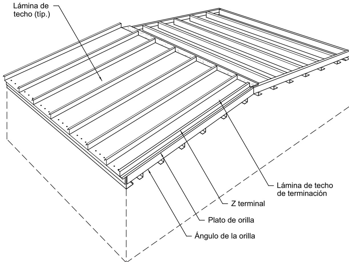
Los detalles en esta sección muestran la instalación de la lámina de terminación y la Z terminal.
