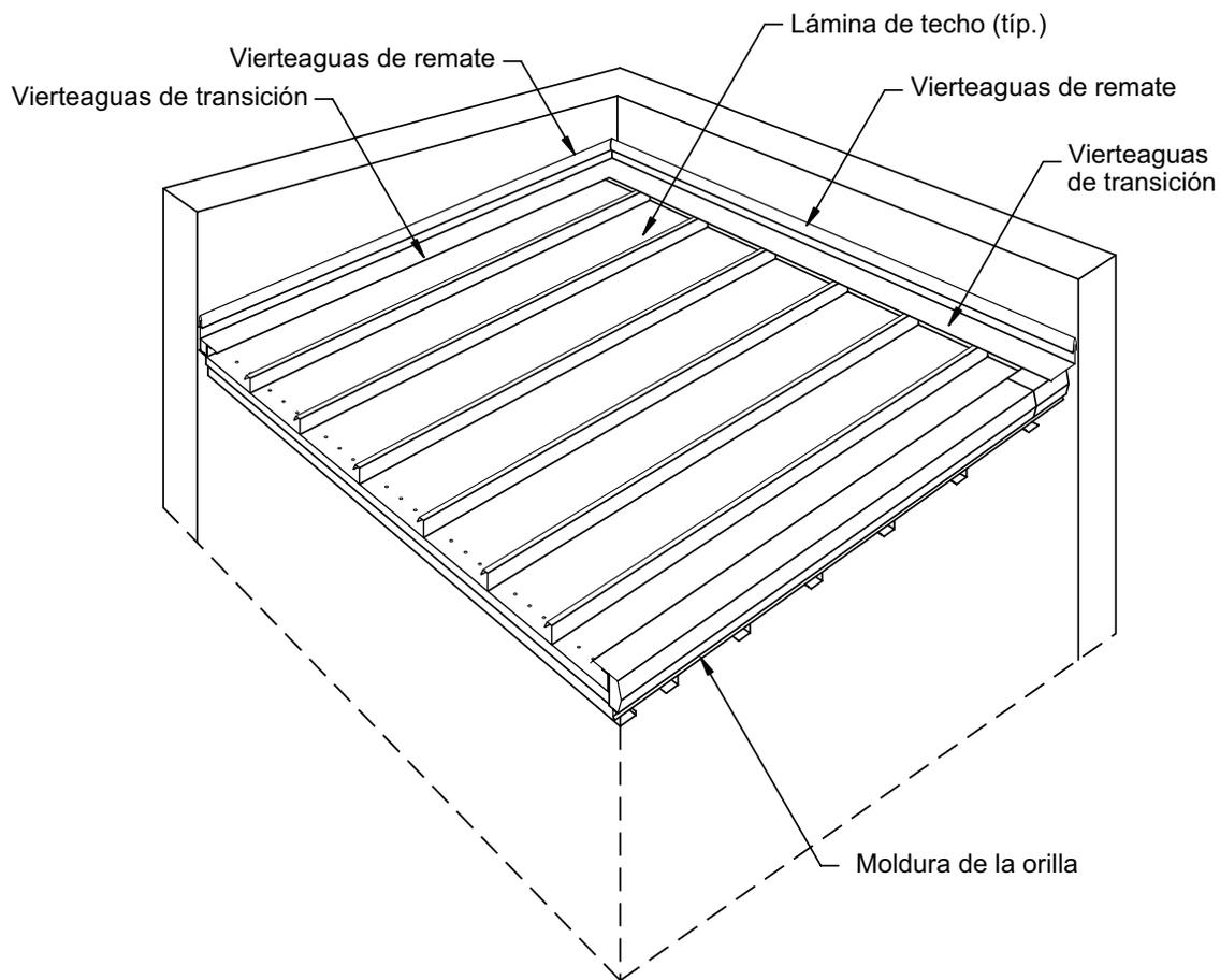
Los detalles en esta sección muestran la instalación del vierendeaguas de la transición del borde alto.
