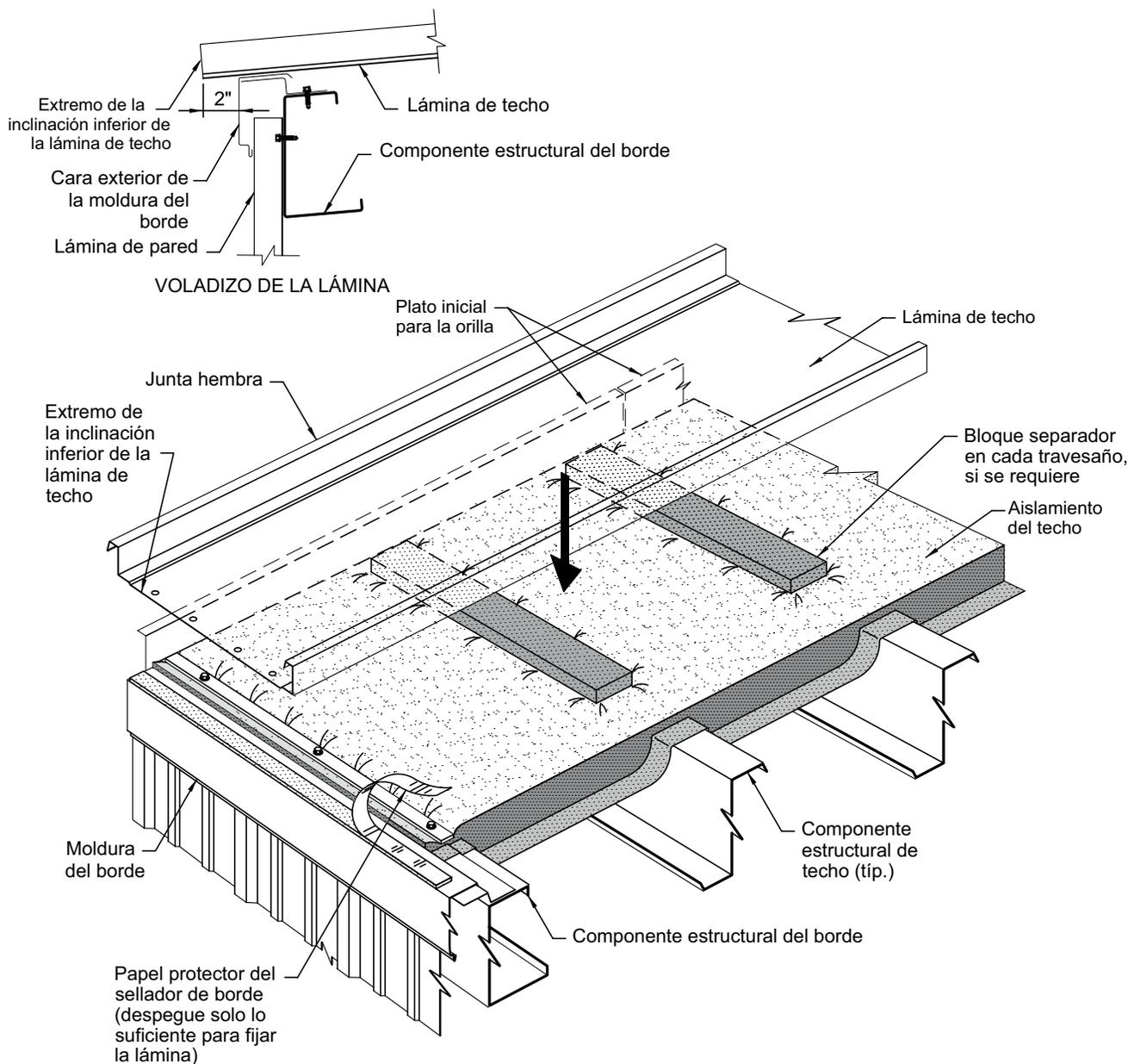
La dimensión del voladizo del borde de la lámina de techo es crítica, pues establece la ubicación de las superposiciones de cierre y los puntos de fijación de la cubierta de la cumbre.
