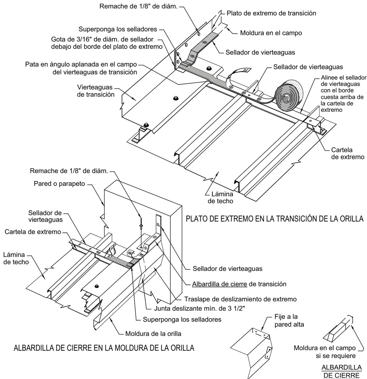
Instale la albardilla de cierre deslizante a la pared usando la moldura de la orilla para localizar la posición.
