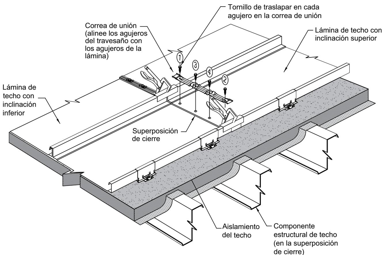
Coloque cuidadosamente la correa de unión sobre los agujeros perforados en la fábrica (si se hicieron) en la lámina de techo.
