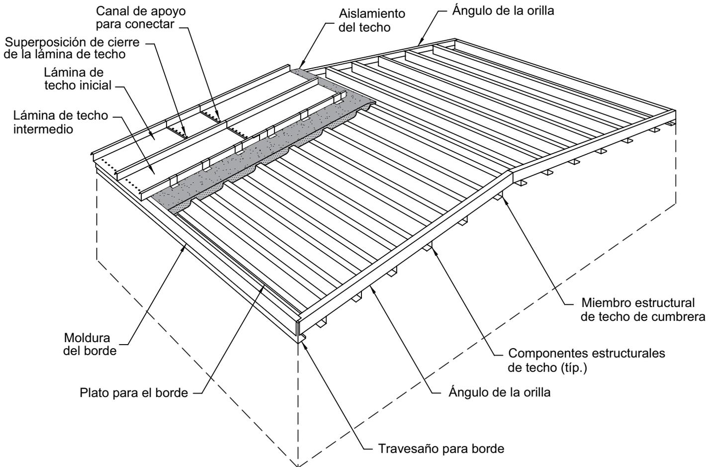
Los detalles en esta sección muestran la instalación de las láminas de techo iniciales e intermedias.
