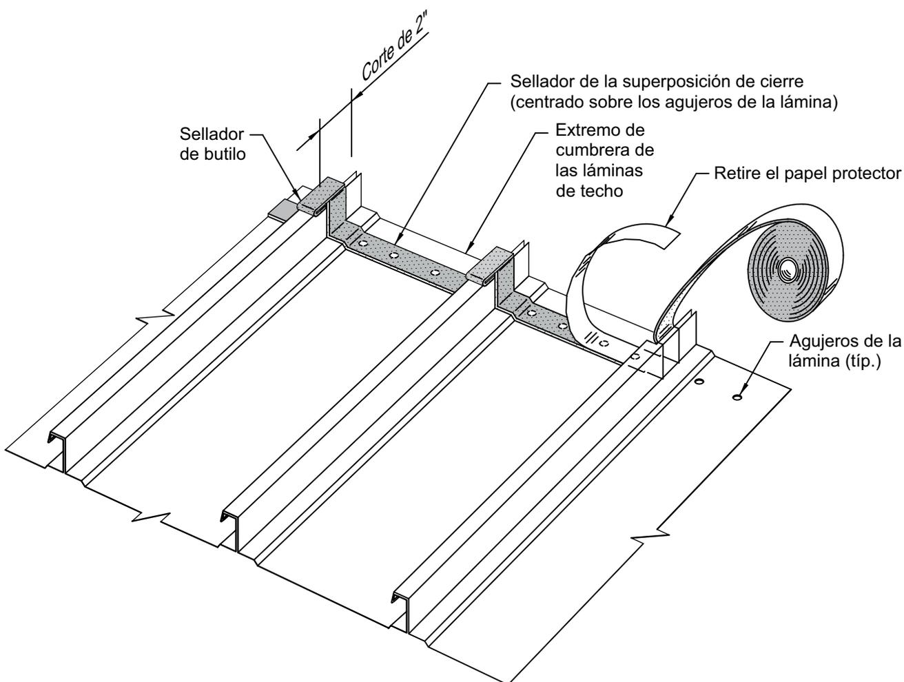
Antes de instalar el sellador en la superposición de cierre, la superficie de la lámina de techo debe dejarse limpia y seca.
