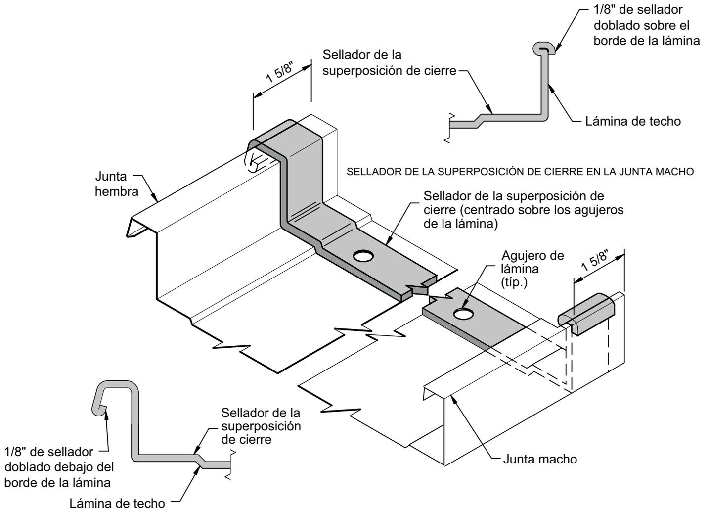
Corte el sellador de la superposición de cierre que va a ajustar alrededor de las juntas de la lámina de techo, como se muestra.
