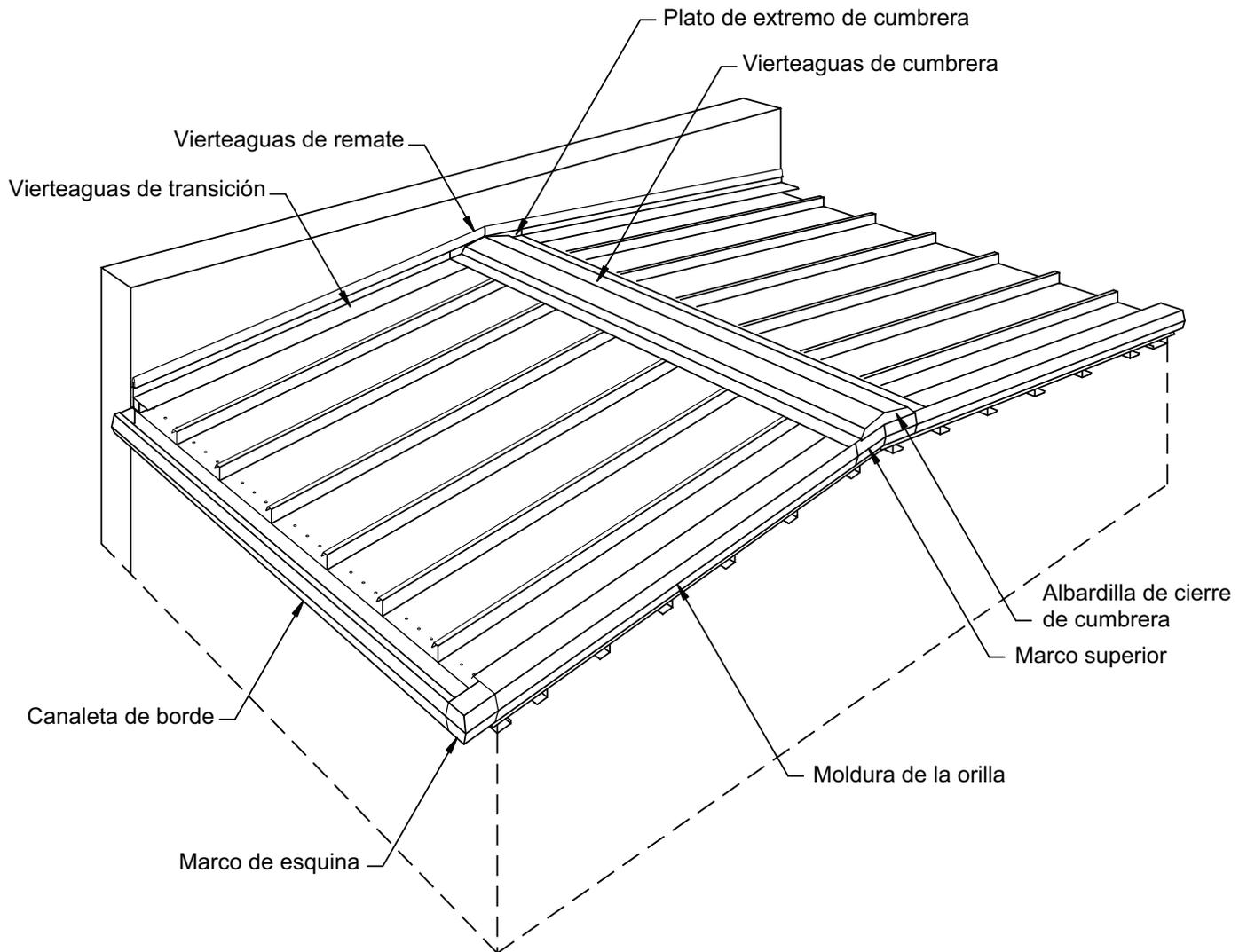
Los detalles en esta sección muestran la instalación de la cubierta de la cumbrera.
