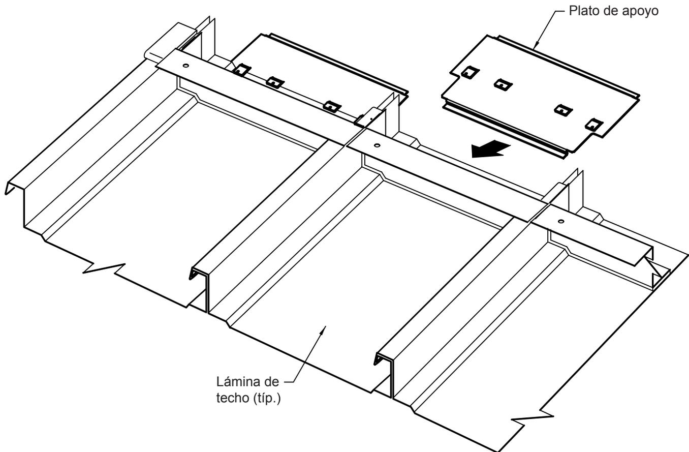
Deslice el plato de apoyo debajo del panel de techo, como se muestra.
