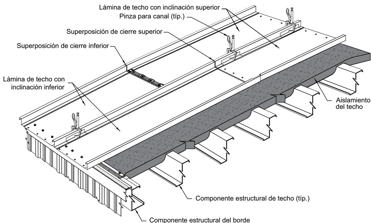
El error más usual en la cobertura es la propagación de las láminas de techo, en especial en los extremos de las láminas. Esto puede ocasionar una cobertura excesiva de la lámina a lo largo del borde, de las superposiciones y de la cumbre.
