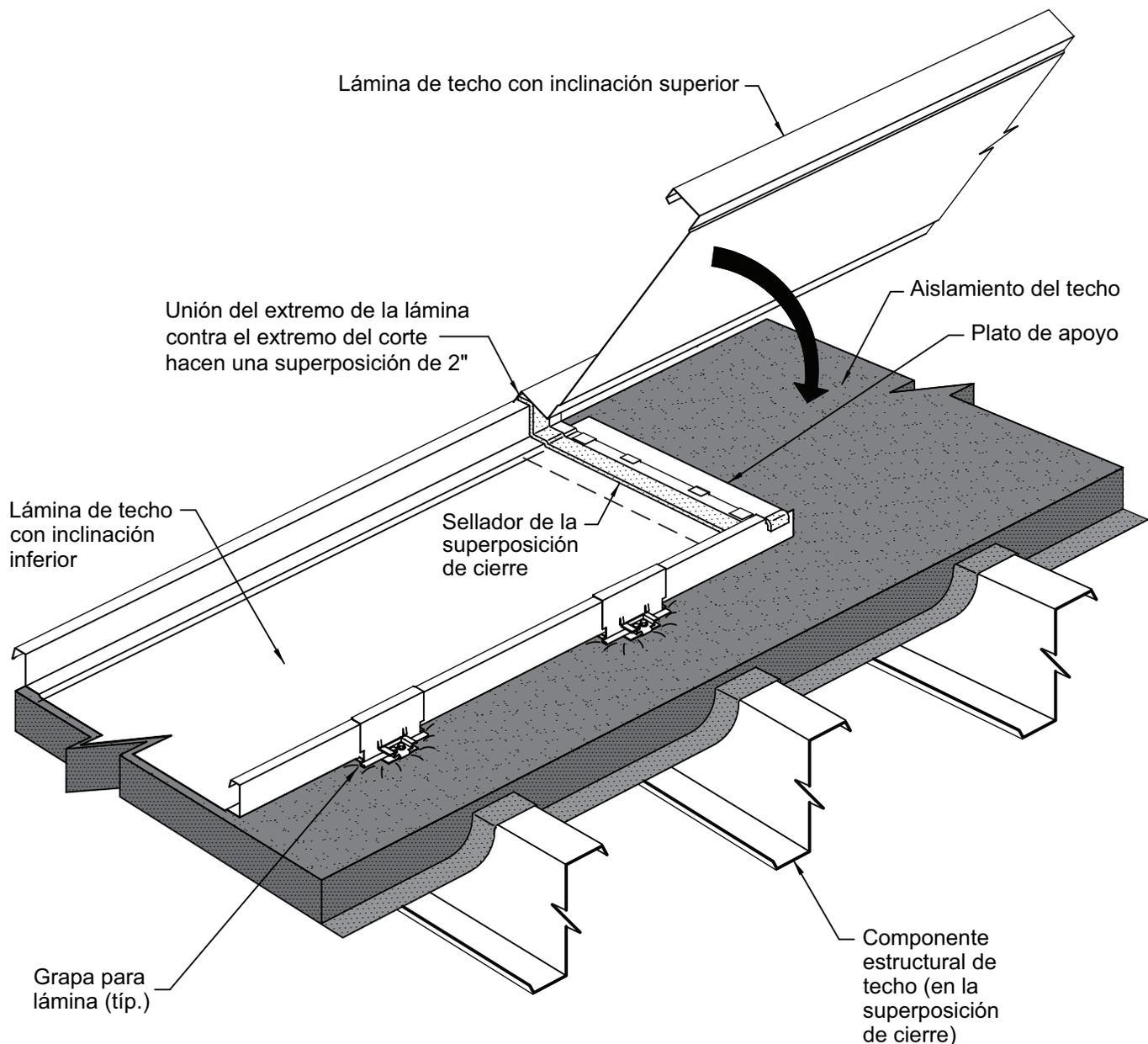
Deje limpia y seca la superficie inferior de la lámina de techo con inclinación superior.
