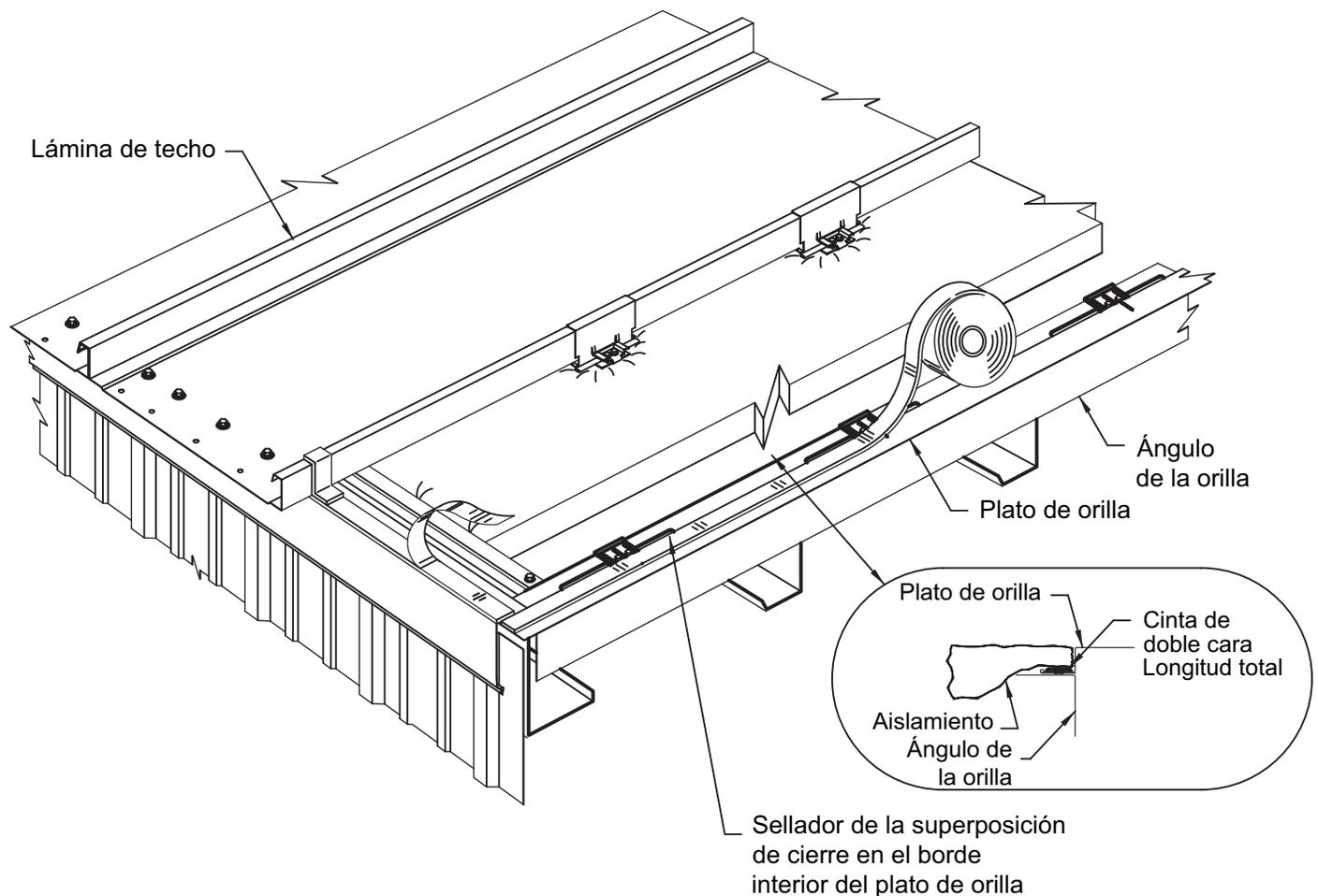
Instale el sellador de la superposición a lo largo del reborde superior del plato de orilla, como se muestra.
