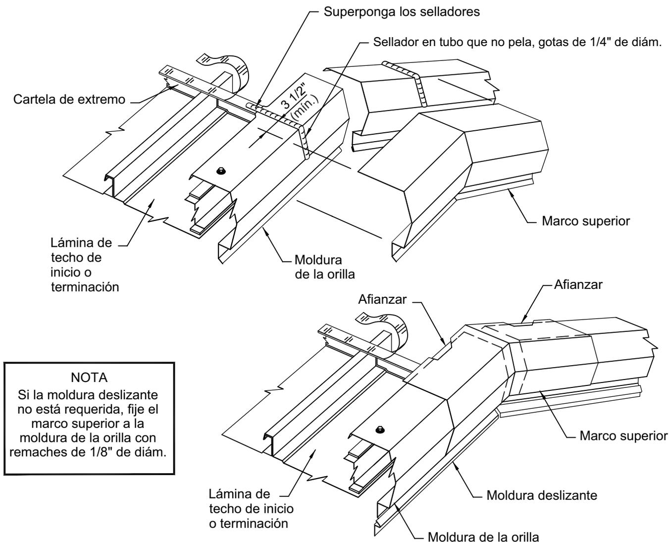
Si la moldura de la orilla no requiere que la moldura deslizante se expanda/contraiga, se puede instalar el marco superior con sellador de tubo y remaches de la misma manera que un empalme.
