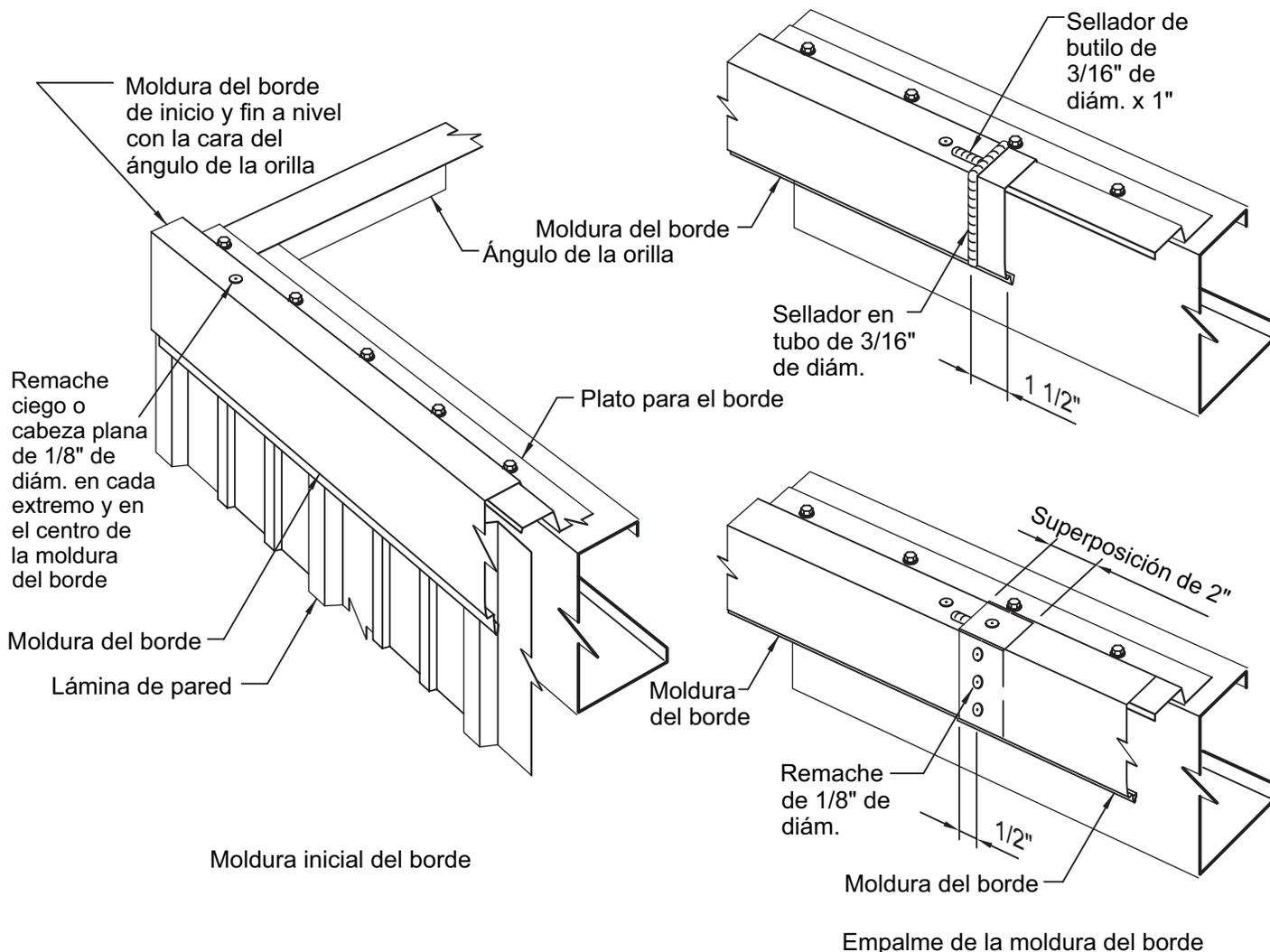
Coloque la moldura del borde sobre el plato para el borde tal como se muestra, y alinee la cara de la moldura del borde con la cara de la lámina de pared.
