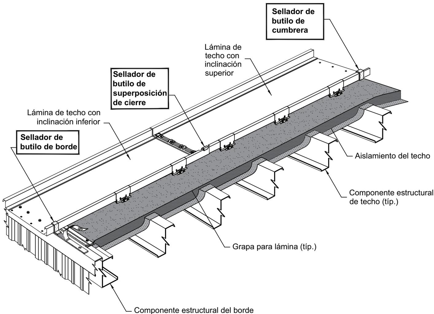
**Los selladores de butilo deben instalarse correctamente antes** de poder instalar el siguiente tendido de láminas de techo.
