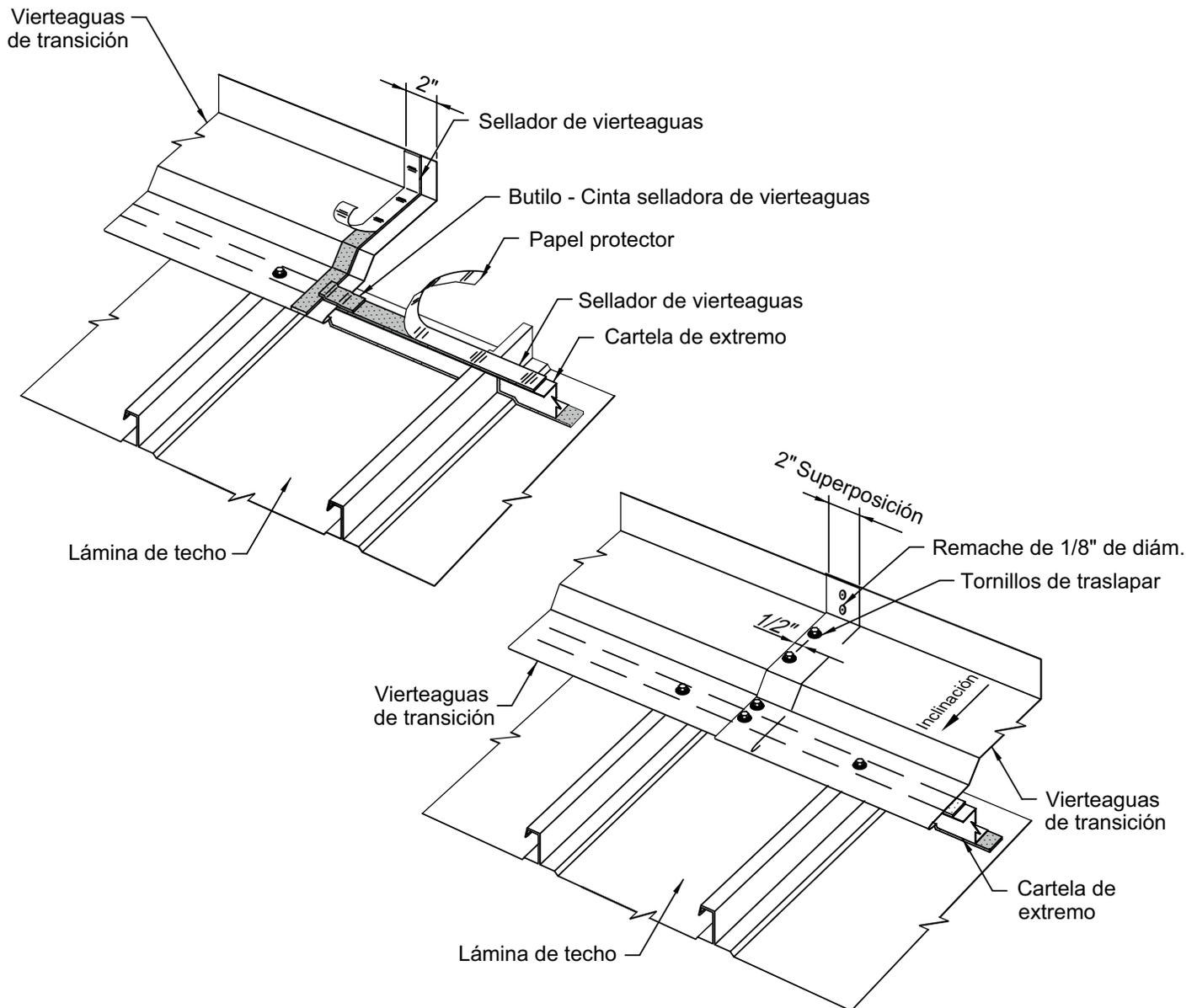
Ensamble los empalmes del vieriteguas de la transición con sellador para vieriteguas y tornillos de traslape, como se muestra.
