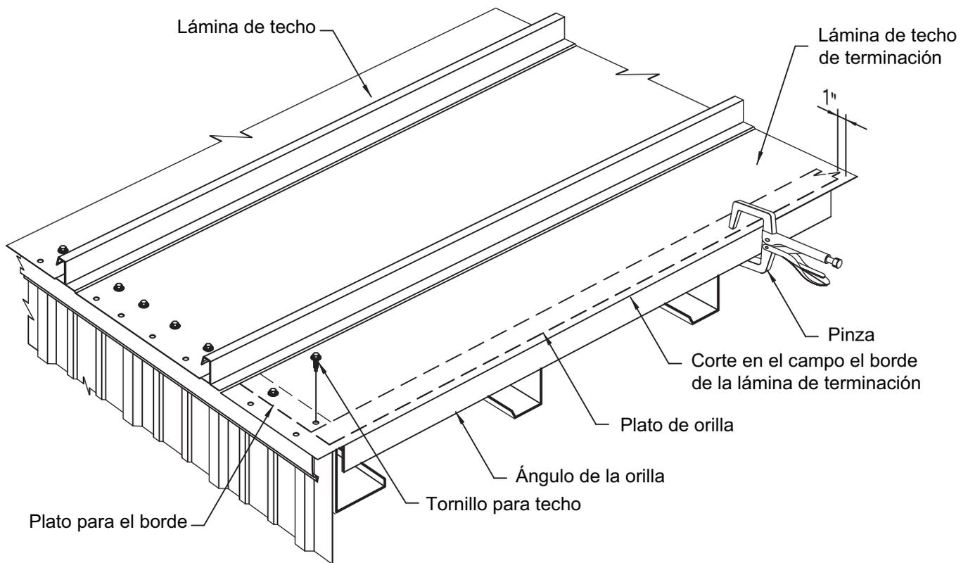
Corte en el campo la lámina de techo de terminación con la anchura requerida. El borde de corte de la lámina debe alargarse 1 pulgada más allá del borde exterior del reborde superior del plato de orilla. (Para la lámina con doblez en el campo opcional debe alargarse 2 pulgadas para hacer el recorte adecuado.)
