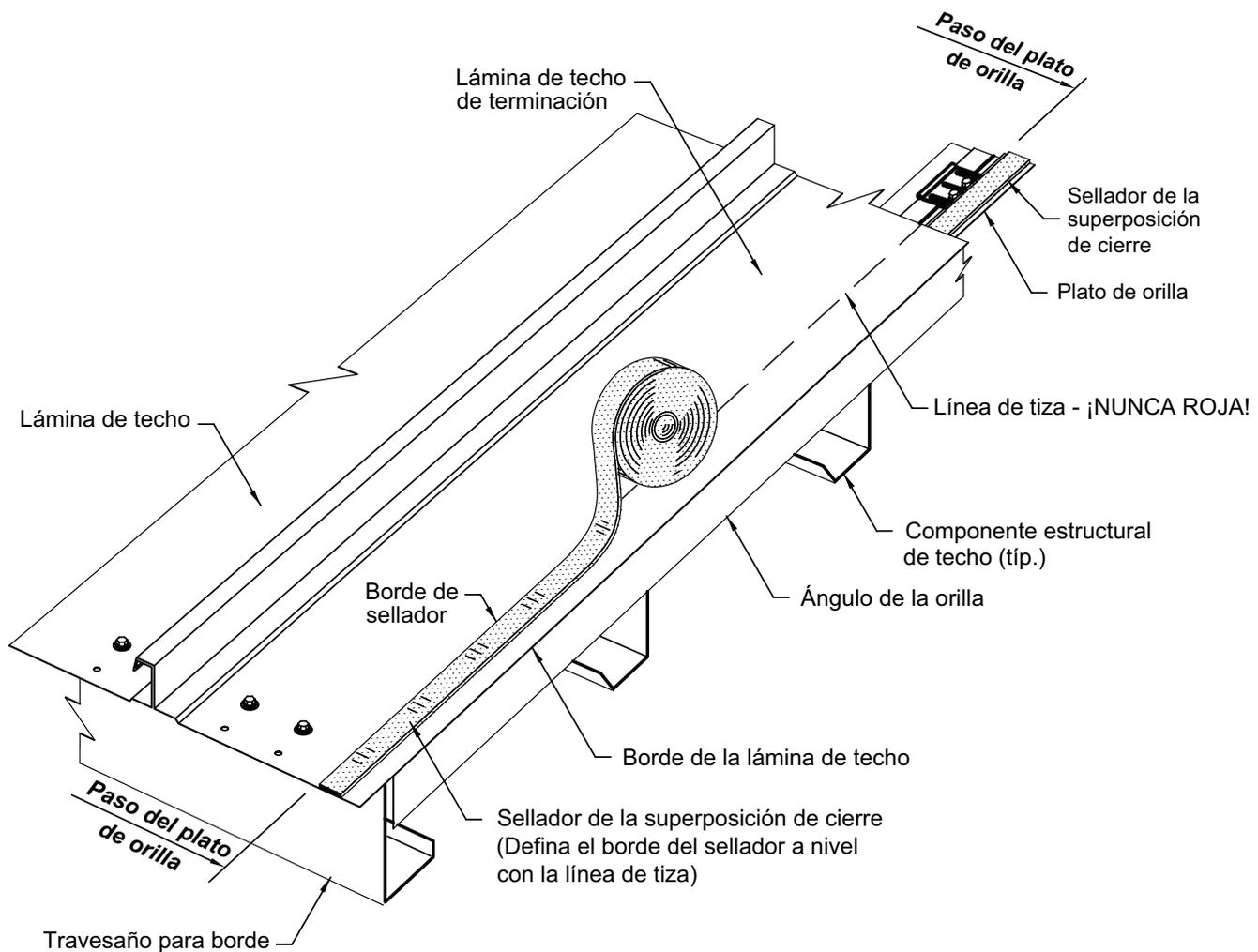
A lo largo del borde de corte de la lámina de techo de terminación, deje limpia y seca la superficie superior.
