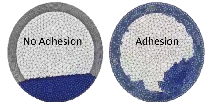
DEM modelling powder adhesion
