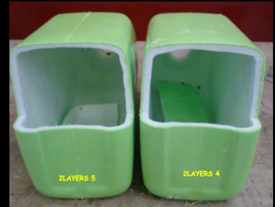
iPP Outer Layer & mPE Inner Layer
