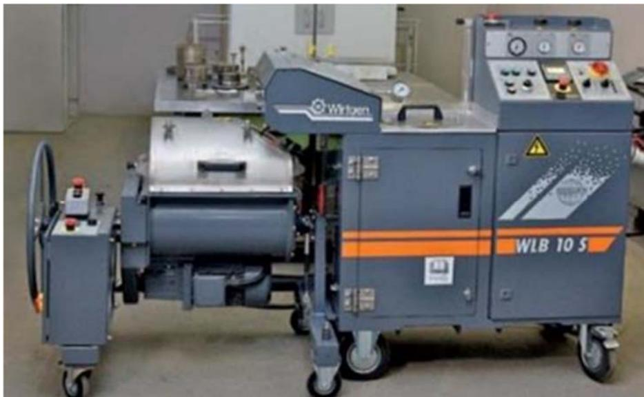
**Figure 95. Wirtgen WLB 10S Foaming Unit**
